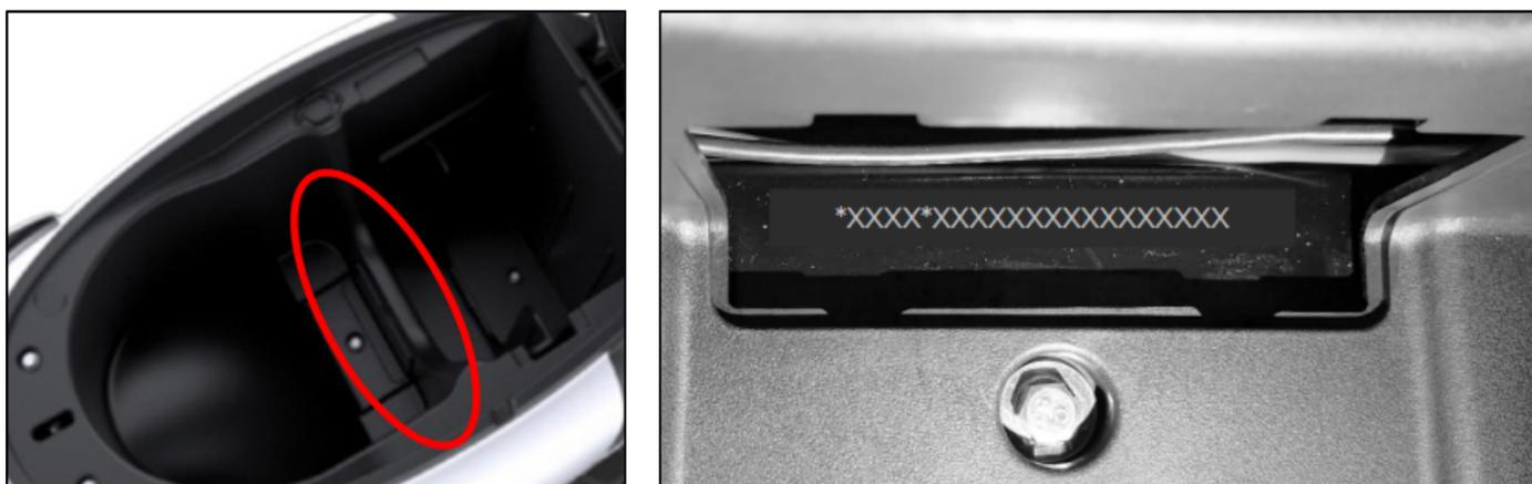
O código de série do motor está localizado na carcaça do motor elétrico, integrado a roda traseira da motocicleta, conforme mostrado nas Figuras 3 e 4.
